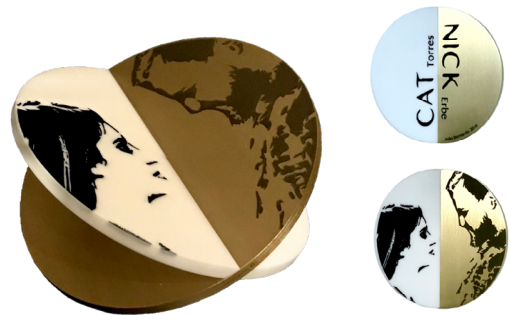
Figura 7 — Exemplo de gravação a laser para escurecimento do latão na medalha Casamento de Catarina e Nick (João Bernardo, Latão e Vidro Acrílico, Ø 80 mm, 2019). A gravação sobre vidro acrílico foi pintada para se obter o contraste. Fotografia: João Bernardo.
