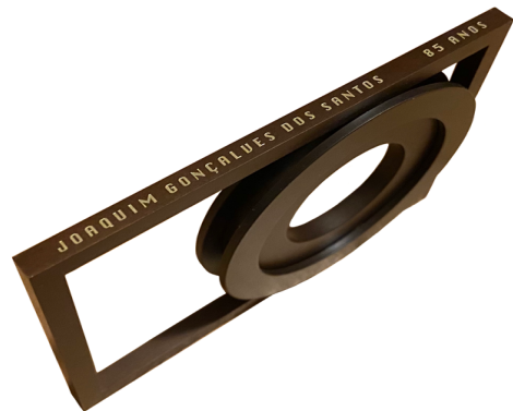
Figura 7 — Exemplo de gravação a laser para escurecimento do latão na medalha Casamento de Catarina e Nick (João Bernardo, Latão e Vidro Acrílico, Ø 80 mm, 2019). A gravação sobre vidro acrílico foi pintada para se obter o contraste. Fotografia: João Bernardo.
