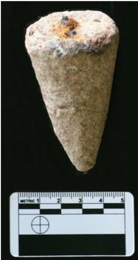
Figura 18 – Fio-de-prumo em chumbo, com veio central em ferro.
